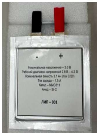
ЛИА с C/Si-анодом и катодом на основе NMC811
